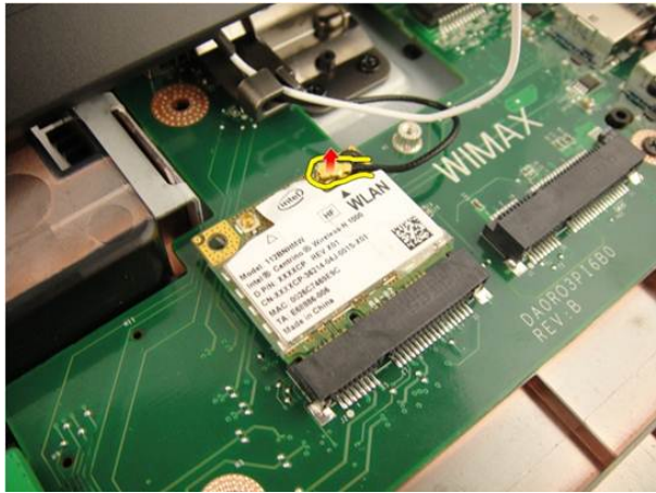
9. הסר את הבורג שמהדק את כרטיס ה-WLAN למקומו.
