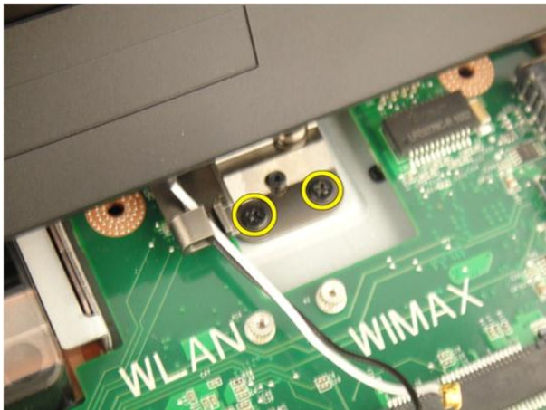
14. הרם כלפי מעלה את מכלול הצג והסר אותו מהמחשב.
