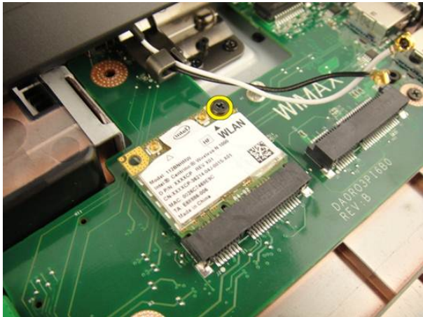
10. משוך את כרטיס ה-WLAN הישר כלפי חוץ מהשקע שלו והסר את הכרטיס.
